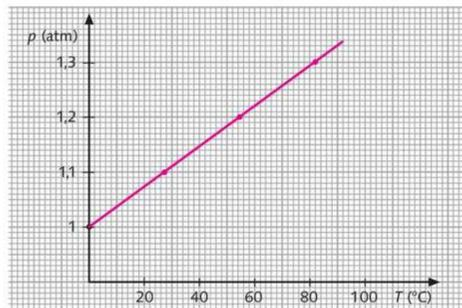
Se obtiene una línea recta. Conviene destacar la importancia de extrapolar la gráfica y observar el punto de corte de la recta con el eje de abscisas.
